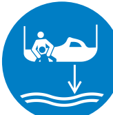
SA 359 Calare in acqua l'imbarcazione di salvataggio durante il lancio in mare
