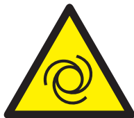
SA 424 Pericolo avviamento automatico
