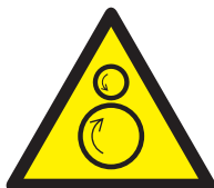
SA 429 Attenzione rulli rotanti/ pericolo di trascinamento
