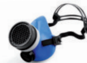
art. sa7354 CE DPI 3ª categoria materiale: gomma TPE ipoallergenica valvola di espirazione centrale in silicone peso: 115 gr circa conf. 16 pezzi UNI EN 140 - valvola a bassa resistenza respiratoria - bardatura ergonomica e regolabile - autoestingente
