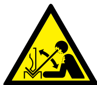
SA 449 Pericolo Spostamento rapido del materiale da piegare nella pressa
