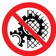
SA 156 Vietato rimuovere le protezioni
