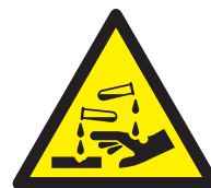
SA 406 Pericolo sostanze corrosive
