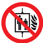
SA 130 Vietato l'uso dell'ascensore in caso d'incendio
