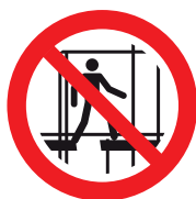
SA 132 Vietato l'uso di questa impalcatura incompleta
