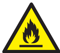
SA 403 Pericolo materiale infiammabile
