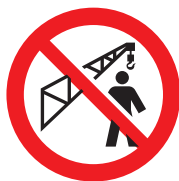
SA 151 Vietato transitare nel raggio di azione della gru
