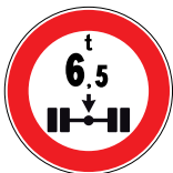
Fig. II 69 Art. 118 Transito vietato ai veicoli aventi massa per asse sup. a ... t
