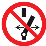
SA 136 Vietato alterare lo stato dell'interruttore
