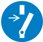
SA 316 È obbligatorio disconnettere il macchinario prima di effettuare manutenzioni
