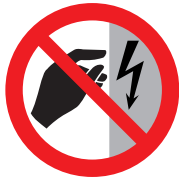
SA 166 Vietato toccare, quadro sotto tensione
